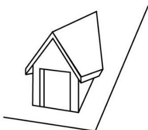
Illustr. 4 - Lucarne en bâtière
